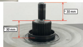
Afbeelding 3: Gewijzigde afmetingen van de vertanding en de geleidepen
