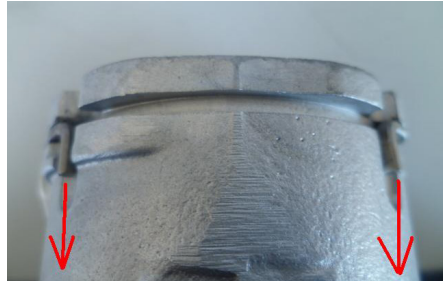
Les deux pointes sont orientées dans le même sens
