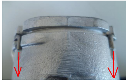
Beide Stifte zeigen in dieselbe Richtung
