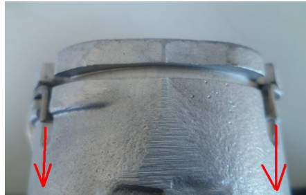
Ambele vârfuli sunt orientate în aceeași direcție
