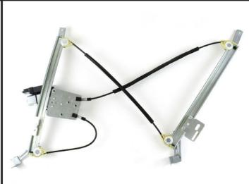
Alzacristallo originale - oem window regulator - lève-vitre original - Fernsterheber von oem - elevalunas original - levantator de vidro original - nosso levantator de vidro - bizim cam acacagi - Γρύλος γνήσιος
