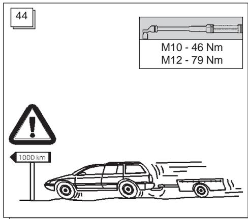
H A jármű gyártója által a vontatásra, és a függőleges terhelésre vonatkozóan közölt specifikációnak a jármű menettulajdonságai szempontjából döntő jelentősége van.
